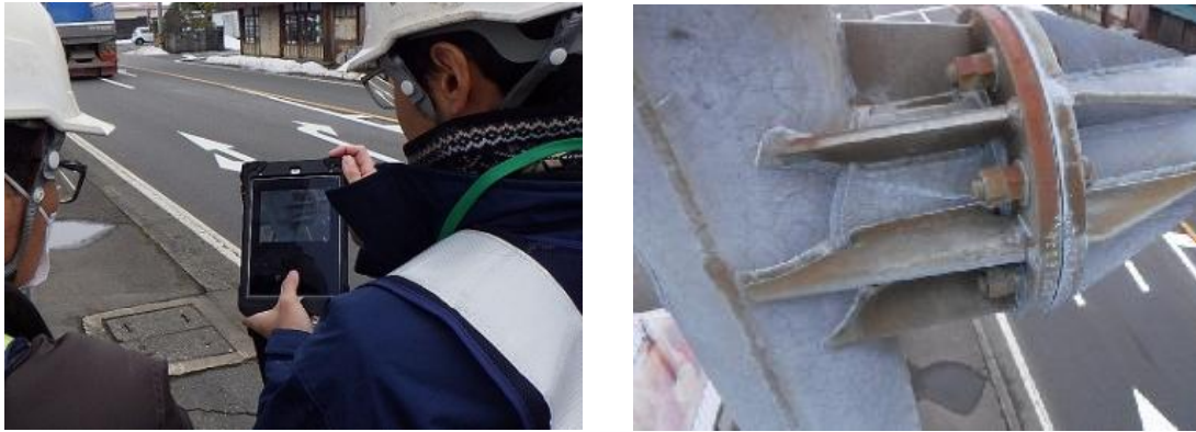
図付 2-1 伸縮支柱付きカメラによる撮影例
